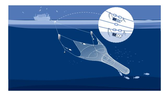
• Les fenêtres d'échappement. En plus des obligations réglementaires usuelles, France Pélagique a recours à cette technologie pour rendre les captures de ses navires plus sélectives. Des filets spécialement conçus permettent aux prises accessoires indésirables de s'échapper par le biais de fenêtres d'échappement.
